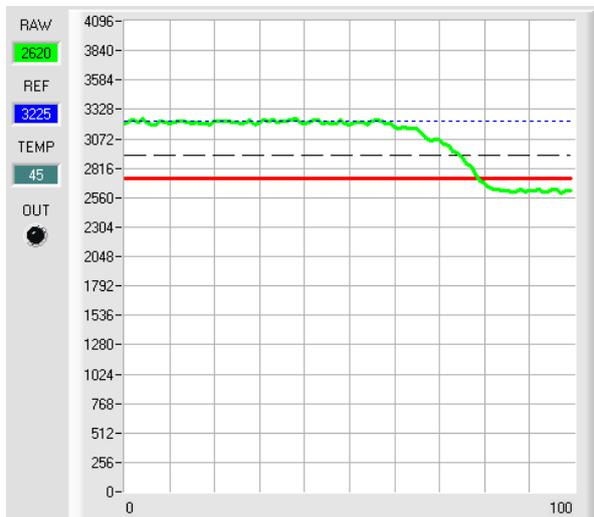
Wenn der aktuelle Messwert **RAW** (grüne Linie) die Schaltschwelle (rote Linie) unterschreitet, wird der Ausgang **OUT0** 0V (Fehler). Dies wird über die LED **OUT** visualisiert
