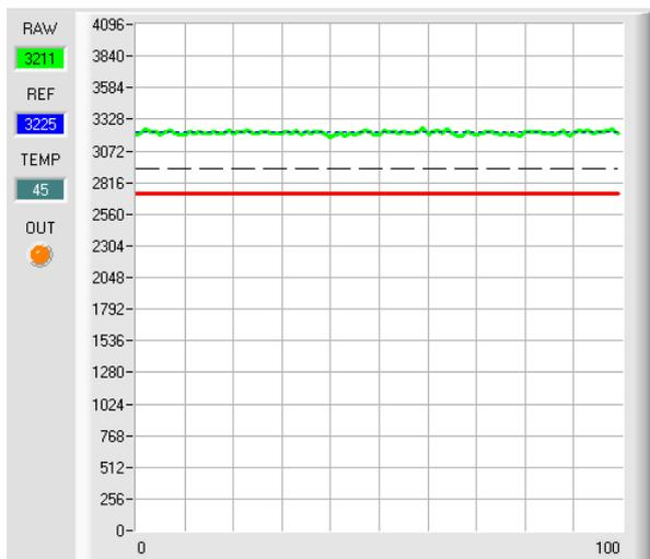
Solange der aktuelle Messwert **RAW** (grüne Linie) oberhalb der Schaltschwelle (rote Linie) liegt, ist der Ausgang **OUT0** auf +24V (Signal ist in Ordnung). Dies wird über die LED **OUT** visualisiert
