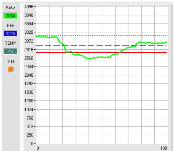
Wird der aktuelle Messwert **RAW** (grüne Linie) wieder größer als die Hystereseschwelle (schwarze Linie), dann wird auch der Ausgang **OUT0** wieder +24V (Signal ist in Ordnung). Dies wird über die LED **OUT** visualisiert
